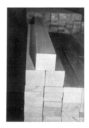
Abbildung 9. Lamellenverleimte Kanteln aus Weisstannenholz für den Fensterbau.
