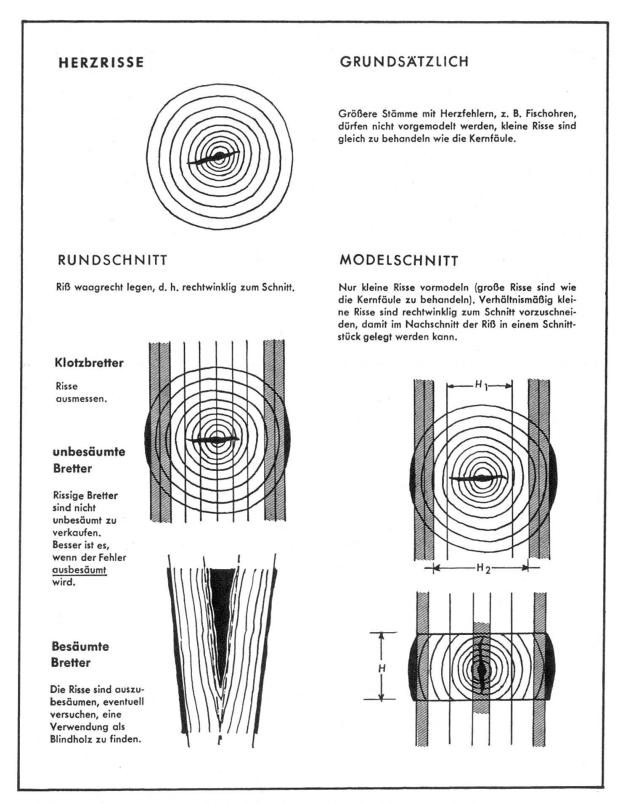
Abbildung 2. Einfluss der Herzrisse auf das Einschneiden des Weisstannenholzes.
