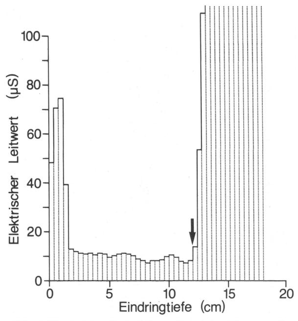
Abbildung 4. Elektrischer Leitwert über dem Radius einer Tanne mit einem kleinen zentralen Nasskern. Vitamatmessung. Splintholzbreite etwa 10 cm, kambialer Leitwert 75  $\mu$ S. Äussere Nasskerngrenze markiert (Pfeil).
