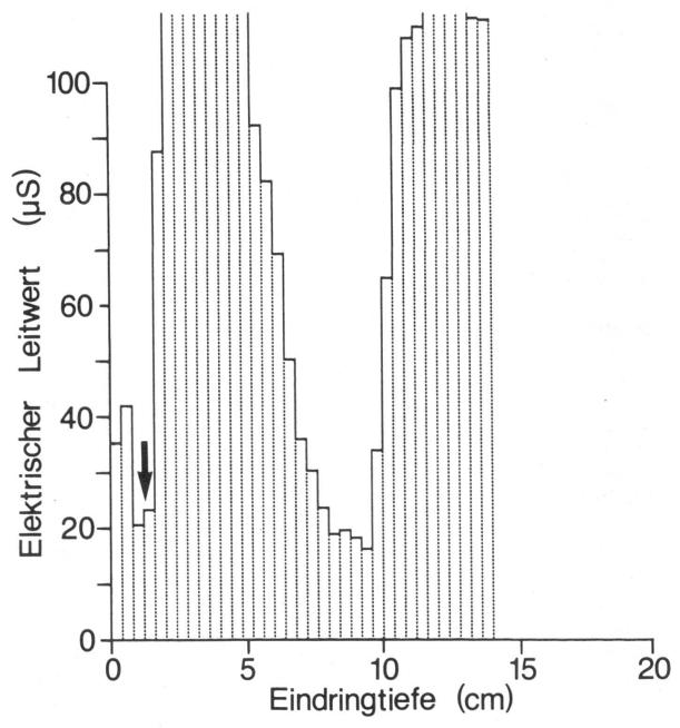
Abbildung 6. Elektrischer Leitwert über dem Radius einer Tanne mit zwei Nasskernzonen. Vitamatmessung. Der äussere Nasskern reicht fast bis zum Kambium. Splintholzbreite reduziert auf etwa 0.5 cm, kambialer Leitwert knapp  $42 \,\mu\text{S}$ . Äussere Nasskerngrenze markiert (Pfeil).
