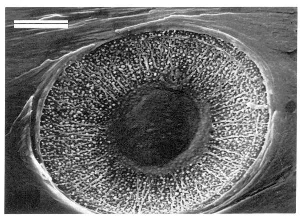
Abbildung 9. Radialschnitt von Tanne, REM-Aufnahme, Marke = 5  $\mu$ m. Verschlossener Hoftüpfel aus hellem (trockenem) Kernholz.
