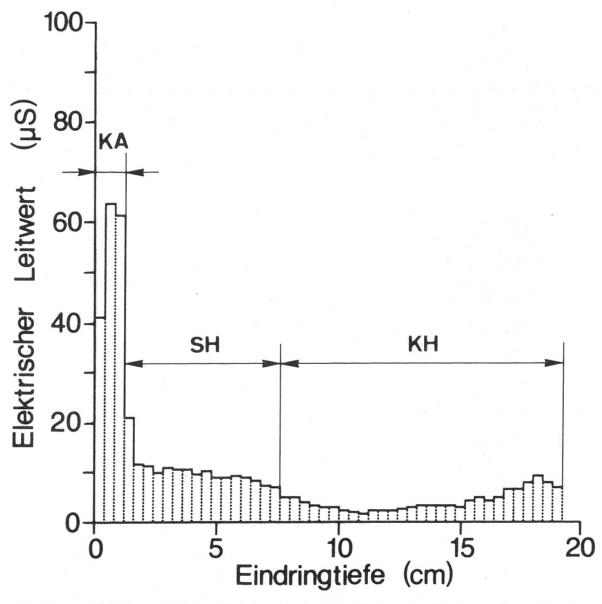
Abbildung 3. Elektrischer Leitwert über dem Radius einer Tanne ohne Nasskern. Vitamatmessung. Splintholzbreite etwa 10 cm, kambialer Leitwert 62  $\mu$ S. KA = kambiale Zone, SH = Splintholz, KH = helles Kernholz.
