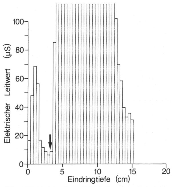
Abbildung 5. Elektrischer Leitwert über dem Radius einer Tanne mit einem Nasskernkreisring. Vitamatmessung. Splintholzbreite etwa 2 cm, kambialer Leitwert 69  $\mu$ S. Äussere Nasskerngrenze markiert (Pfeil).
