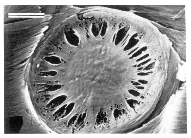
Abbildung 10. Radialschnitt von Tanne, REM-Aufnahme, Marke =  $5 \mu m$ . Verkrusteter Hoftüpfel aus Nasskernholz mit Bakterienbefall.
