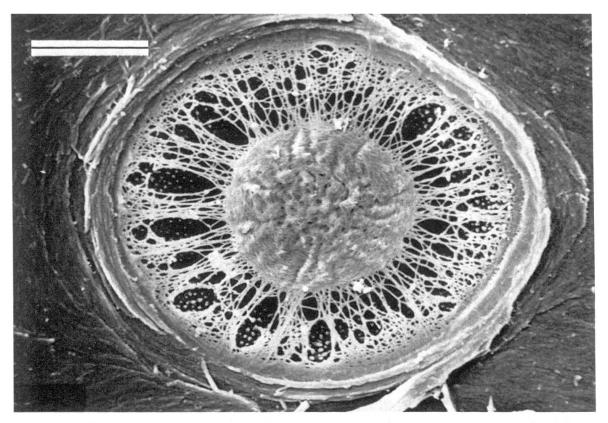
Abbildung 8. Radialschnitt von Tanne, REM-Aufnahme, Marke = 5  $\mu$ m. Offener Hoftupfel aus dem Splintholz.
