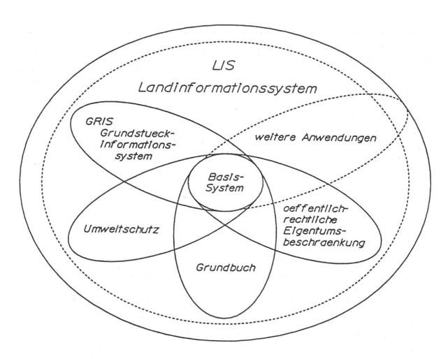
Abbildung 1. Modellvorstellung eines Landinformationssystems. Das Basissystem enthält Daten, die von mehreren Anwendern gebraucht werden. Das Denkmodell verwendet verschiedene Datenebenen, die miteinander kombiniert werden können. (Darstellung U. Höhn)
