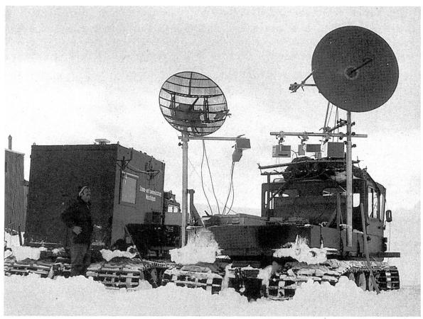
Abbildung 5. Radargeräte auf Schneefahrzeug (Lukmanier, GR).
