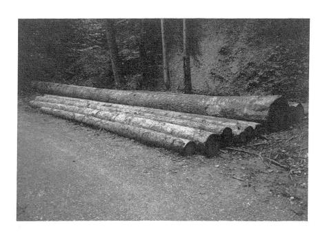
Abbildung 3. Rundholzstapel für Schutzmitteltest.
