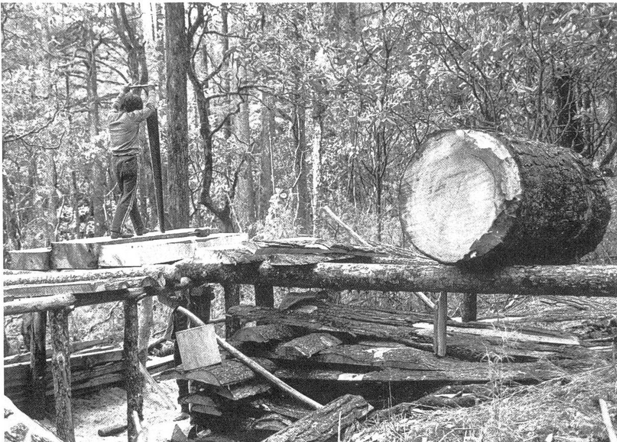
Abbildung 3. Ein Teil des Rundholzes wird noch im Bestand von Handsägern zu Kantholz weiterverarbeitet (Bild P. Moser).
