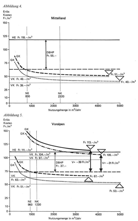
Abbildungen 4 und 5. Vergleich des mittleren Holzerlöses mit den Holzerntekosten in den wichtigsten Gebietstypen der Forstregionen Mittelland und Voralpen, in Abhängigkeit von der Jahresnutzung. Deckungsbeitrag oder Verlust des Teilbetriebes Holzproduktion bei der mittleren Nutzungsmenge von einzeln bewirtschafteten Betrieben, Kopfbetrieben und bei maximaler Auslastung der Kapazitätseinheit.
