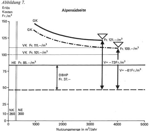
Abbildungen 6 und 7. Vergleich des mittleren Holzerlöses mit den Holzerntekosten in den wichtigsten Gebietstypen der Forstregionen Alpen und Alpensüdseite, in Abhängigkeit von der Jahresnutzung. Deckungsbeitrag oder Verlust des Teilbetriebes Holzproduktion bei der mittleren Nutzungsmenge von einzeln bewirtschafteten Betrieben, Kopfbetrieben und bei maximaler Auslastung der Kapazitätseinheit.
