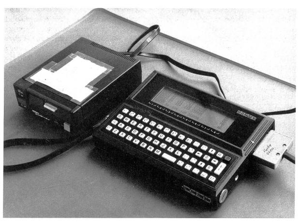
Abbildung 1. Husky-Hunter mit batteriebetriebener Diskettenstation.
