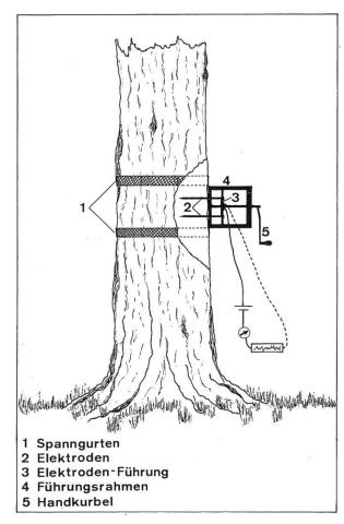
Abbildung 2. (oben). Das Messprinzip des Vitamats im Schema. Hauptbestandteile der Messeinrichtung und Messanordnung: 1 Spanngurten, 2 Elektroden, 3 Elektroden-Führung, 4 Führungsrahmen, 5 Handkurbel.
