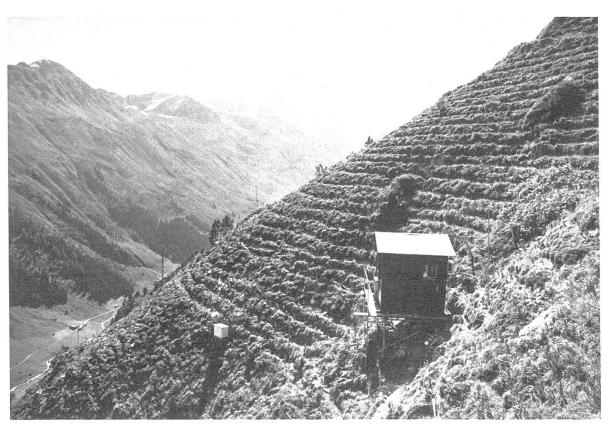
Abbildung 4.1 a. Gaswechselmessplatz in der Grossen Runse. Rechts im Vordergrund liegt der gutbesonnte, ostenexponierte und links (weisse Wetterhütte) der nordexponierte Standort. In der Hütte befinden sich die Mess- und Regelgeräte.
