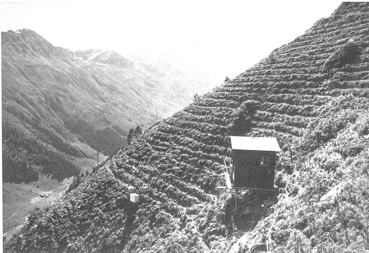
Abbildung 4.1 a. Gaswechsellmessplatz in der Grossen Runse. Rechts im Vordergrund liegt der gut-besonnte, ostenexponierte und links (weisse Wetterhütte) der nordexponierte Standort. In der Hütte befinden sich die Mess- und Regelgeräte.
