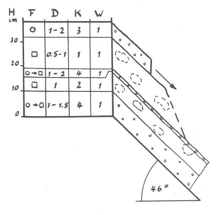
Abbildung 2: Schneeprofil beim Anriss A 1 am Gugelberg, 23. Januar 1987, 11.00 Uhr. Die oberste Schicht war am Vortag, zum Zeitpunkt des Lawinenanbruches, feucht und weich, gefror jedoch in der Nacht.
