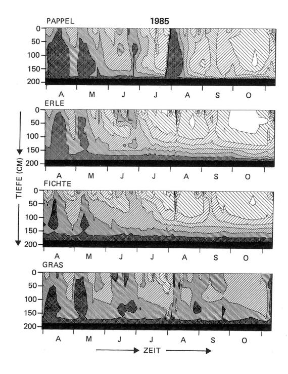
Abbildung 4. Isoplethendarstellung des zeitlichen Verlaufs der Saugspannungsverteilung über die Tiefe der vier Lysimeter während der Vegetationsperioden 1984 (gegenüberliegende Seite) und 1985. Zwischen Anfang März und Anfang April 1984 wurde der Wasserspiegel in den Lysimetern von 1,10 m auf 1,87 m Tiefe abgesenkt.
