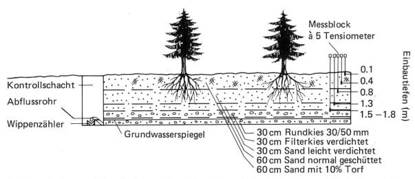
Abbildung 2. Schematisches Bodenprofil und Funktionsprinzip der Lysimeter (MS 1:50; nach Eyer [1984], abgeändert).
