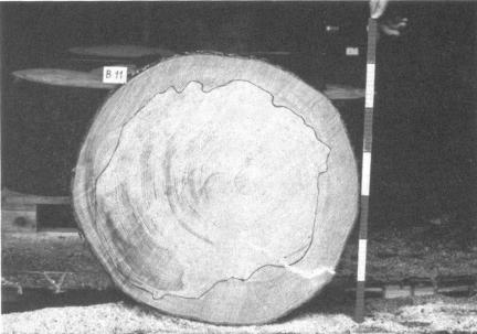
Abbildung 4: Splint-/Kerngrenze unmittelbar nach dem Trennschnitt markiert.
