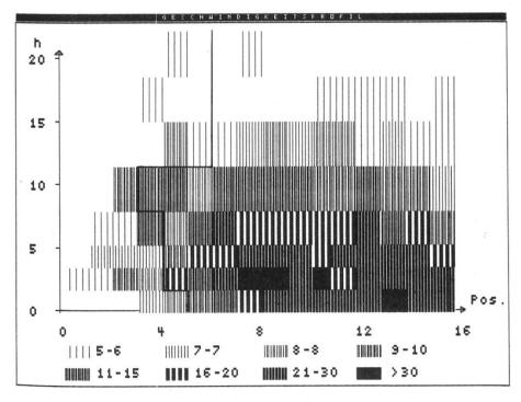
Abbildung 8. Geschwindigkeits-«Längsschnitt» durch den Kopf einer Laborstaublawine. Die schwarze Linie markiert den Dichtesprung von Abbildung 7. Vorausgehende Geschwindigkeiten deuten auf eine Druckwelle vor der Lawine, siehe auch Abbildung 9 unten.
