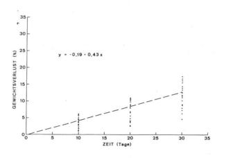
Abbildung 6. Abhängigkeit des Gewichtsverlustes (%) konservierter Proben von der Dauer der Lagerung (Tage). Messwerte (N = 96) und Regressionsgerade.
