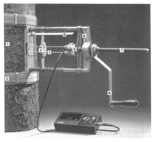
Abbildung 5. Einrichtung zur kontinuierlichen Messung der Holzfeuchtigkeit (%) respektive des elektrischen Widerstandes (kOhm) am Radius stehender Bäume. 1....Baumstamm; 2....Spanngurten mit Halterung; 3....Elektroden; 4....Elektroden-Führung (Knickschutz) mit Druckfedern; 5....Elektroden-Halterung; 6....Führungsrahmen; 7....Gewindestange; 8....Handkurbel; 9....Massstab.
