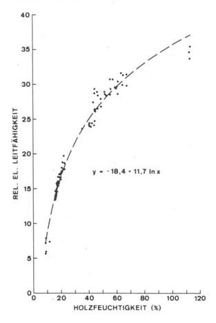
Abbildung 3. Zusammenhang zwischen der relativen elektrischen Leitfähigkeit des Holzes und der Holzfeuchtigkeit (%). Messwerte (N = 100) und Regressionskurve.
