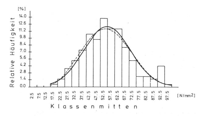
Biegebruchspannung grosser Proben des ersten Klimas
