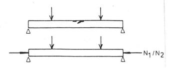
Abbildung 6. Festigkeitsversuchskonzept.
