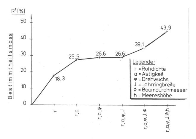
Abbildung 3. Bestimmtheitsmass R<sup>2</sup> für die Biegebruchspannung von Schweizer Fichtenholz in Abhängigkeit der berücksichtigten Kenngrössen (EPFL).
