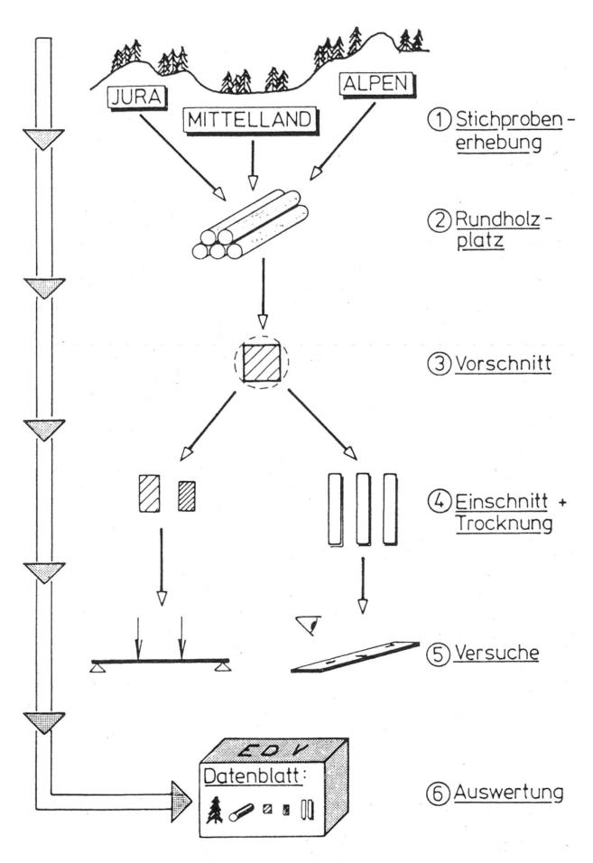
Abbildung 4. Schematische Darstellung des Untersuchungsablaufes.
