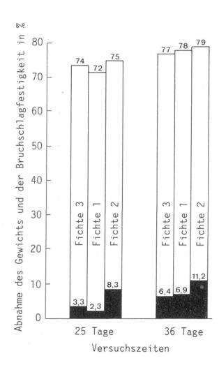
Abbildung 9. Abnahme des Gewichtes (schwarze Balken) und der Bruchschlagfestigkeit (weisse Balken) durch Einwirkung eines holzzerstörenden Pilzes.
