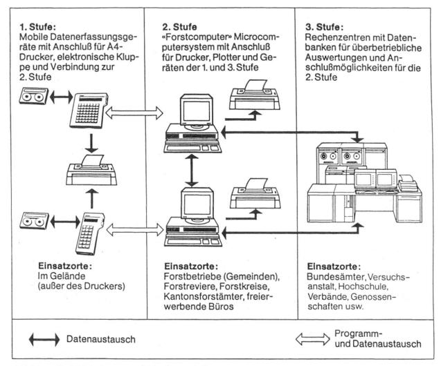
Abbildung 1. Verbindung von 3 Hardwarestufen.
