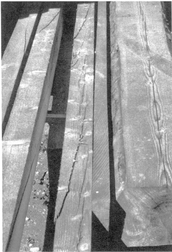
Abbildung 5. Die Entspannung der Wachstums- spannungen durch Fällen des Baumes und Ein- schneiden in Balken und Bretter verläuft ent- lang der Holzfasern. Das Zurückspringen der Risse in die ursprüngliche Rissebene ist deutlich zu beobachten.
