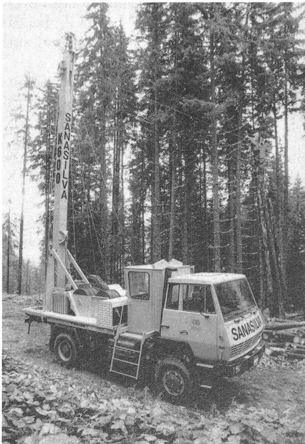
Abbildung 1. Der mittlere Mobil-Seilkran kann alle Sortimente bergauf und bergab transportieren.
