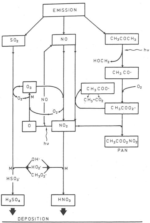
Abbildung 3. Photochemische Transformationen von SO2, NO und Kohlenwasserstoffen. (8)
