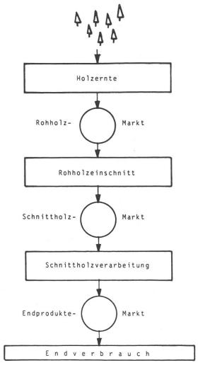
Abbildung 1. Schema des Produktionsprozesses.
