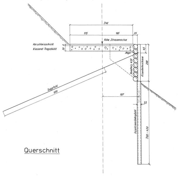
Abbildung 1. Schematischer Querschnitt durch den wiederhergestellten Strassenkörper.
