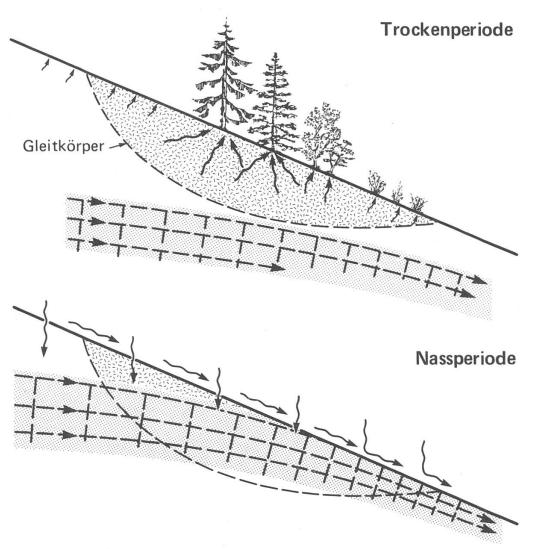
Abbildung 2. Bodenwasserverhältnisse während einer Trocken- und einer Nassperiode. Eingezeichnet sind derselbe potentielle Gleitkörper und die Fliessrichtung infiltrierten Wassers kombiniert mit der «Grundwasserströmung» (schematisch).
