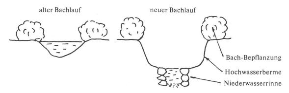
Abbildung 3. Bei hochwassersicherem Ausbau eines Bachlaufes muss darauf geachtet werden, dass trotz Querschnittvergrösserung auch nach der Korrektion die Beziehung zwischen Leben im Wasser und der Bestockung bestehen bleibt. Im alten Bachlauf war diese Beziehung vorhanden, wogegen sie nach der Korrektion fehlt.
