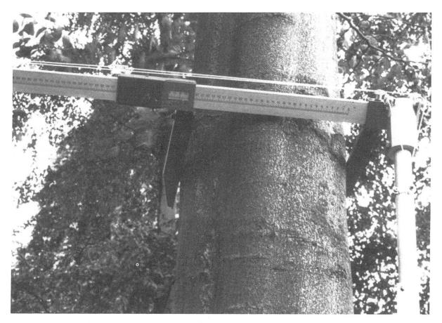
Abbildung 3. Kluppe zur Messung oberer Stammdurchmesser in 3 m, 5 m, 6 m und 7 m Höhe (Nach Rhody).
