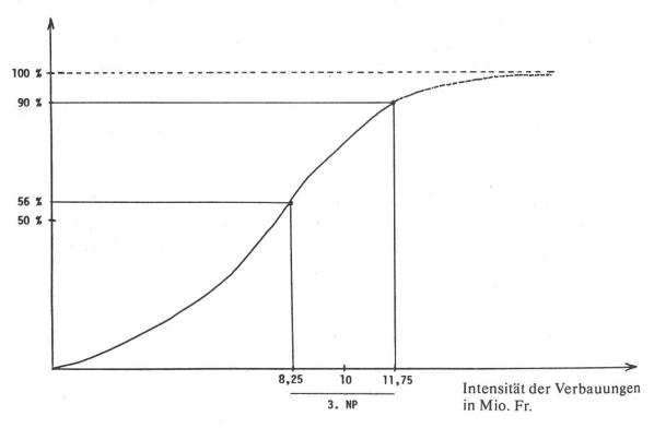
Abbildung 1. Die unterstellten Beziehungen zwischen der Intensität der Lawinenverbauungen in Mio. Fr. und dem Sicherheitsgrad in % für das verbaute Gebiet. (NP = Nachtragsprojekt)
