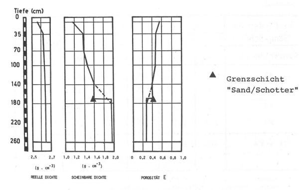
Abbildung 1. Bodenphysikalische Kennwerte (Dichten, Porosität).
