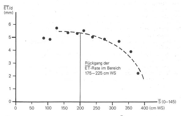
Abbildung 4. Beziehung zwischen der mittleren Saugspannung S im Wurzelraum (0 bis 145 cm Tiefe) und der Evapotranspirationsrate  $\overline{ET}/d$  des untersuchten Standortes.
