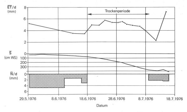
Abbildung 2. Zeitlicher Verlauf der mittleren Evapotranspirationsrate  $\overline{ET}/d$  der mittleren Saugspannung  $\overline{S}$  und der mittleren Niederschlagsrate  $\overline{N}/d$  während der Trockenperiode (18.6. bis 9.7.1976).
