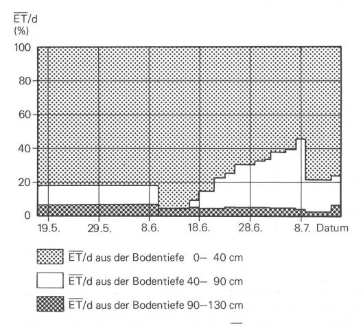
Abbildung 3. Der mittlere, tägliche Wasserentzug ( $\overline{ET}/d$ ,%) aus 3 Kompartimenten in unterschiedlichen Bodentiefen, bezogen auf  $\overline{ET}/d$  (= 100 %) des gesamten Wurzelraumes. Trockenperiode 1976.
