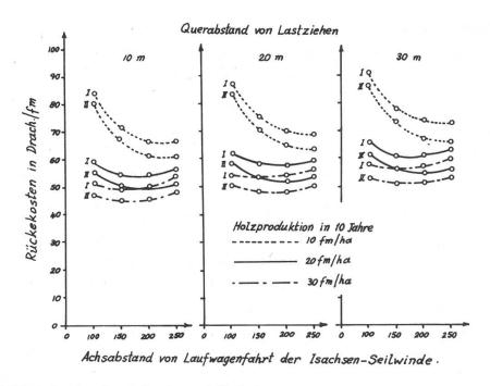
Abbildung 7. Rückekosten durch Isachsen-Seilwinde.
