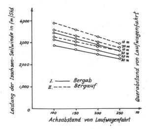
Abbildung 6. Stunden-Leistung der Isachsen-Seilwinde.
