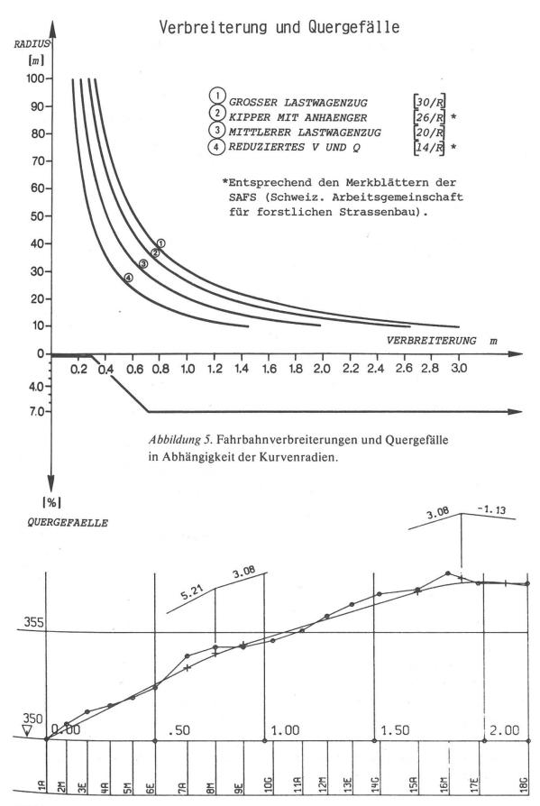
Abbildung 6. Plotterzeichnung: Längenprofil mit Terrainlinie und Gradiente.
