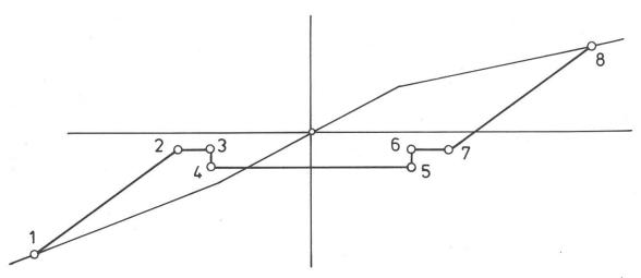
Abbildung 4. Massgebende Querprofilpunkte für die Massenberechnung.
