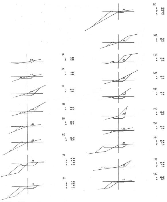
Abbildung 7. Plotterzeichnung: Querprofile mit Kotendifferenz, laufender Länge, Zwischendistanz, Fahrbahnverbreiterung und Querneigung.
