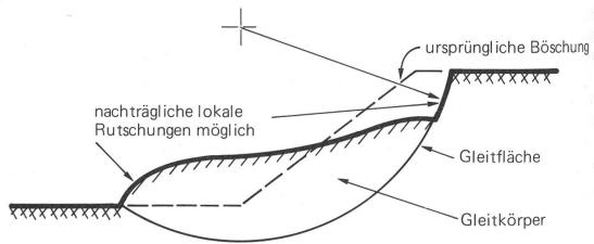
Abbildung 1. Beispiel einer relativ tiefliegenden, kreisförmigen Gleitfläche.
