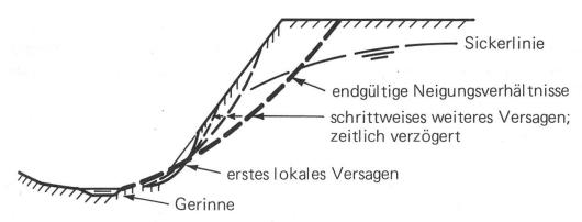
Abbildung 2. Schrittweise Reduktion der Böschungsneigung durch oberflächennahes Abgleiten.
