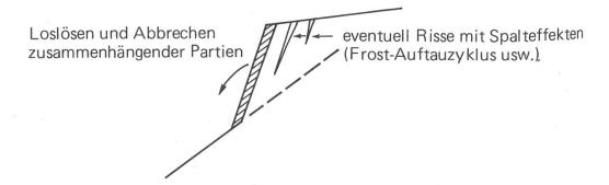
Abbildung 4. Detail Abbruchzone (Bereich 3 von Abbildung 3) schematisch.
