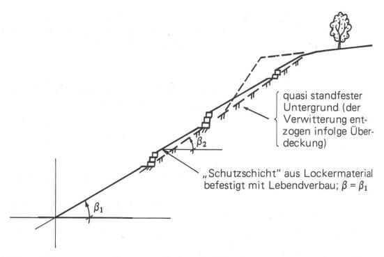
Abbildung 5. Anordnung der Stützwerke (schematisch) im Bereich der Zonen 2 und 3 von Abbildung 3.
