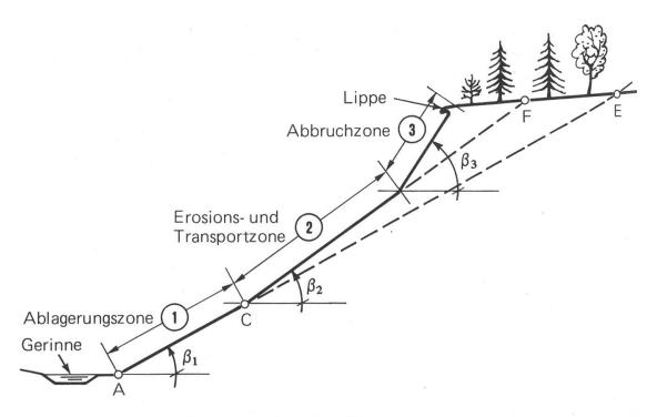
Abbildung 3. Typisches Profil eines Erosions-Rutschhanges.
