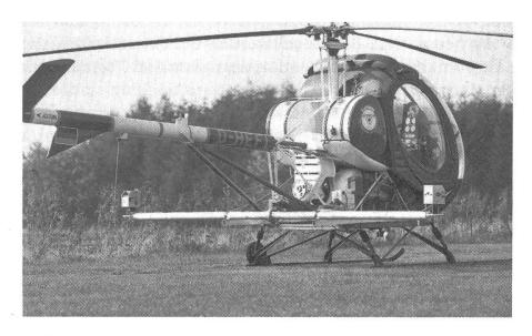
Abbildung 1b: Kameraausrüstung wie auf Abbildung 1a; Montage an einem leichten Helikopter Hughes 300. (Die Langfilmkamera, teilweise verdeckt, befindet sich unterhalb der Helikopter-Batterie.)
