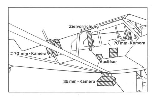
Wichtig für die Waldaufnahme ist eine richtige Exposition, namentlich wenn es sich um einen hohen Nadelholzanteil der Bestände und somit um eine geringe Reflexion handelt. Zur Vermeidung von Bewegungsunschärfen sollte eine möglichst kurze Exposition erfolgen. Bei Kameras mit Schlitzverschluss ist die Bewegungsschärfe sehr gering, wenn der Schlitz entgegengesetzt zur Flugrichtung verläuft.
