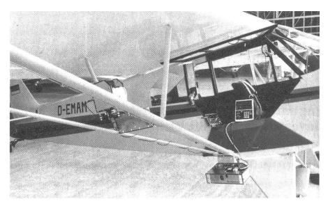
Abbildungen 1a: Kameraausrüstung für kleinformatige Luftaufnahme mit zwei 70-mm-Kameras (für Bildmessungen) und einer 35-mm-Langfilmkamera (für Übersichtsaufnahmen bzw. Luftbildstreifen mit 60prozentiger Stereoüberdeckung). Die drei Kameras werden über ein aufladbares Batteriepack synchron über ein variierbares Intervallometer vom Cockpit automatisch ausgelöst. Montage an einer Piper PA 18. Vergleiche Bild und Sketch darunter.
