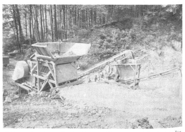
Abbildung 3. Backenbrecher (links) und Hammermühle (rechts) zur Aufbereitung von Trägund Verschleissschichtmaterial (Photo: Firma H. Renggli, Malters)
