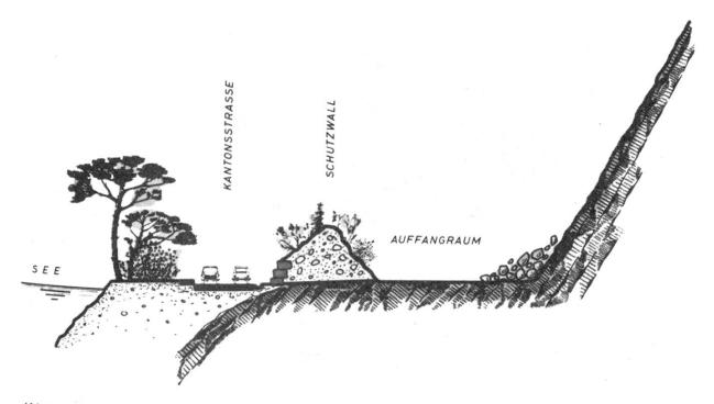
Abbildung 6. Querschnitt durch den Steinbruch «Fallenbach». Nach Beendigung der letzten Sicherheitssprengungen und Aufräumungsarbeiten wird der Steinbruch eingestellt und der zwischen Strasse und Steinbruch erstellte Damm begrünt und bepflanzt.
