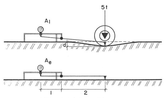
Abbildung 12. Prinzip der Deflektionsmessung.
