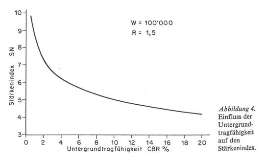
Die Messung des CBR-Wertes im Feld- oder Laborversuch (SNV 670 315 und 670 320a) ist zeit- und materialaufwendig und für die Baupraxis ungeeignet. Zur Messung oder Schätzung des CBR-Wertes stehen daher nur die folgenden praktikablen Möglichkeiten zur Verfügung:
