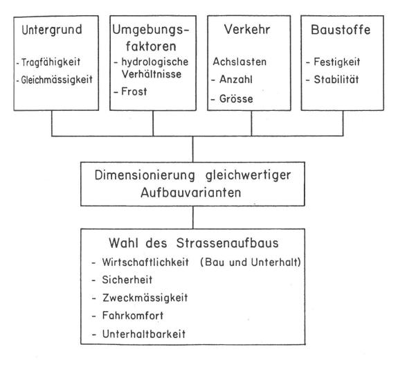
Abbildung 2. Schema der Oberbaudimensionierung (1).
