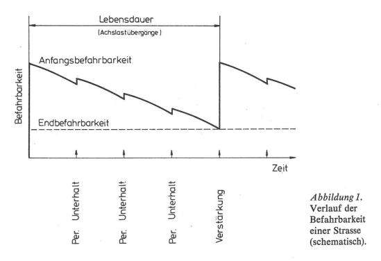
lastübergängen definiert, nach der die Strasse nicht mehr mit dem notwendigen Fahrkomfort befahrbar ist. In dieser Zeit wird die Endbefahrbarkeit erreicht, ohne dass dabei mehr als der laufende und periodische Unterhalt notwendig ist. Bei Erreichung der Endbefahrbarkeit ist die Strasse nicht zerstört, sie muss jedoch erneuert werden. Diese Erneuerung besteht in der Verstärkung des Oberbaus und der Wiederinstandstellung der Ebenheit der Fahrbahn.
