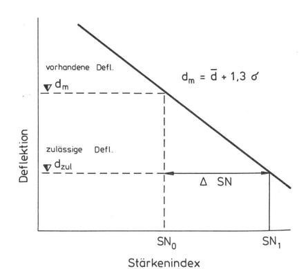
Abbildung 13. Verstärkung einer Strasse nach der Deflektionsmethode (schematisch)
