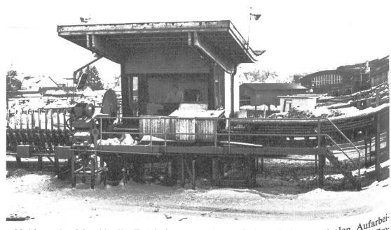
Abbildung 3. Maschinelle Entrindung von Stammholz auf dem zentralen Aufarbeitungsplatz. Jeder gelieferte Robschaft kann auf tungsplatz. Jeder gelieferte Rohschaft kann entsprechend dem Auftragseingang und produktionsprogramm des Holzhofes antimal (Foto: Bildarchiv BAF) duktionsprogramm des Holzhofes optimal eingeteilt und ausgenützt werden.
