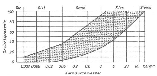
Darstellung 11. Bereich der mit bituminösen Bindemitteln stabilisierbaren Böden.
