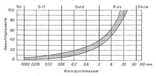
Darstellung 5. Kalk-wasser-gebundenes Verschleissschichtmaterial.
