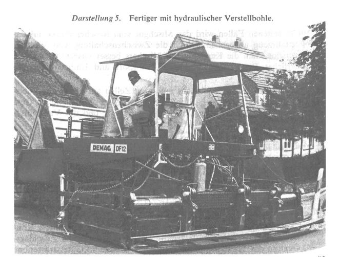
Die ausfahrbare Extensorbohle ermöglicht die stufenlose Verstellung der Einbaubreite. Auf den einspurigen Wald- und Güterstrassen mit der häufig wechselnden Fahrbahnbreite (Kurvenradien) sollten nur noch solche Einbaumaschinen eingesetzt werden.
