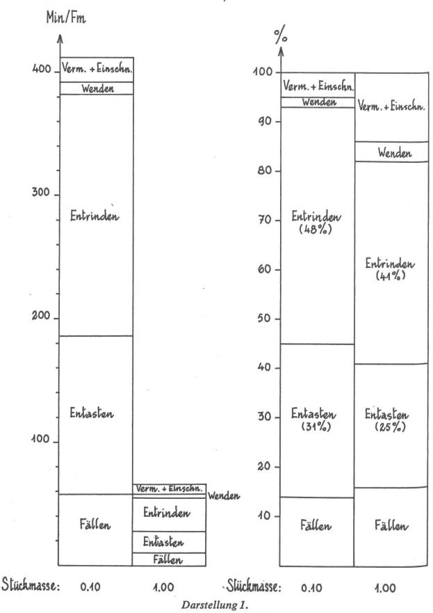
So ergibt sich bei der Mechanisierung der Entrindung bei der Aufarbeitung mittelstarker Fichte ein Mechanisierungsgrad von etwa 40 %, bei der Mechanisierung der Entastung und Entrindung bei schwacher Fichte ein Mechanisierungsgrad von etwa 80 %.
