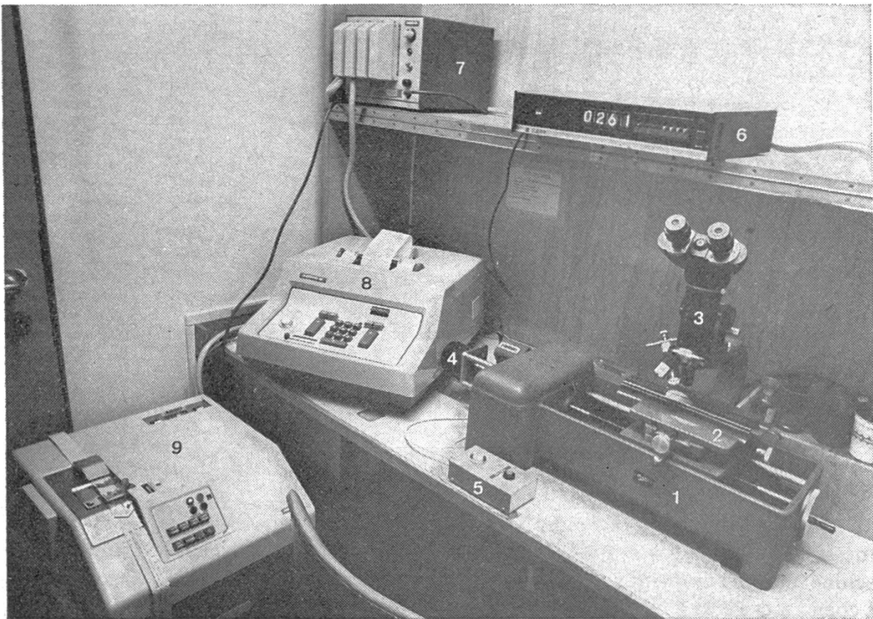
Zusammenstellung der verbesserten Jahrring-Messapparatur am Arbeitsplatz.
