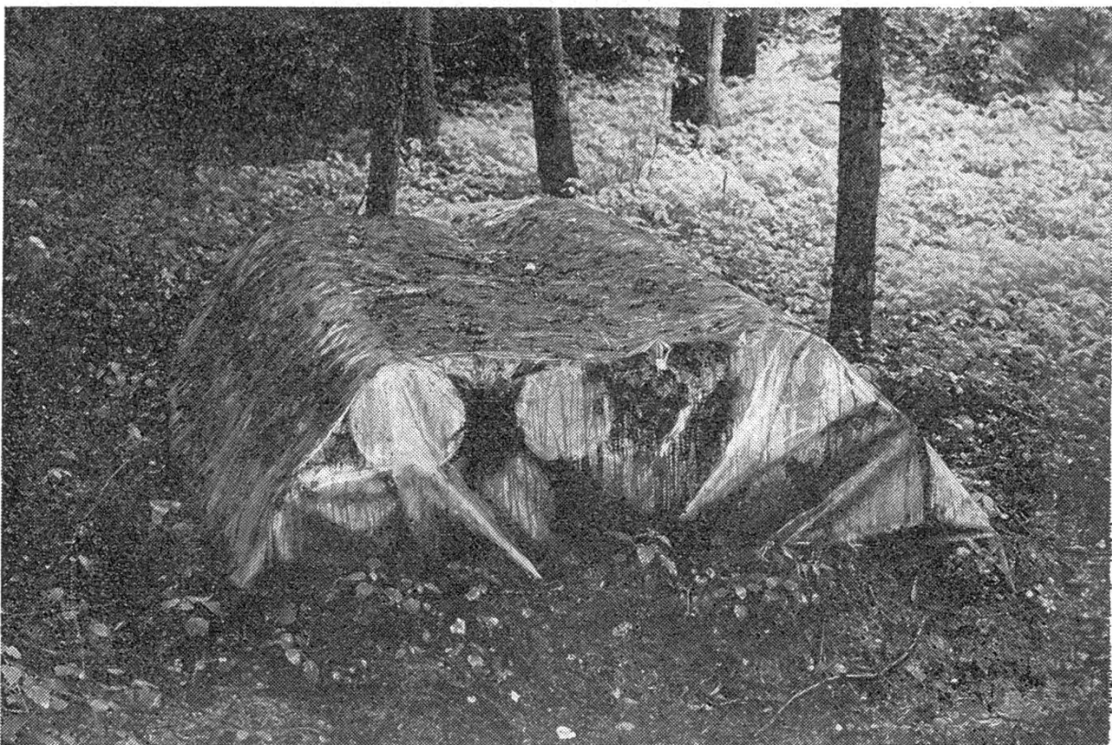
Abbildung 2. Versuchspolter in einer schattigen Mulde nach 10 Monaten Lagerungsdauer. Das Kondensationswasser an der Plastik-Innenseite weist auf eine hohe Luftfeuchtigkeit hin.
