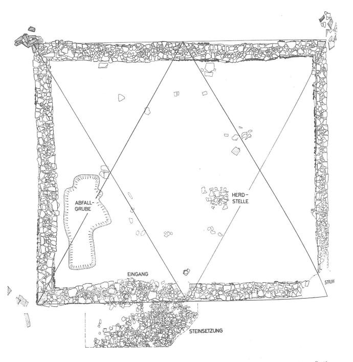
Abbildung 6. Riehen-Maienbühl: Vergleiche auch Abbildung 5. Grundriss eines römerzeitlichen Gebäudes aus dem 1. Jahrhundert n. Chr. Mit einer Länge von 12,8 m (Basis) und einer Breite von 11,05 m (Höhe) leitet sich seine Proportion vom gleichseitigen Dreieck ab (Schnurvermessung). — Massstab 1:100.
