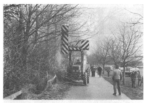
Die Maschine im Einsatz beim zweiten Durchgang auf maximale Schneidhöhe eingestellt.
