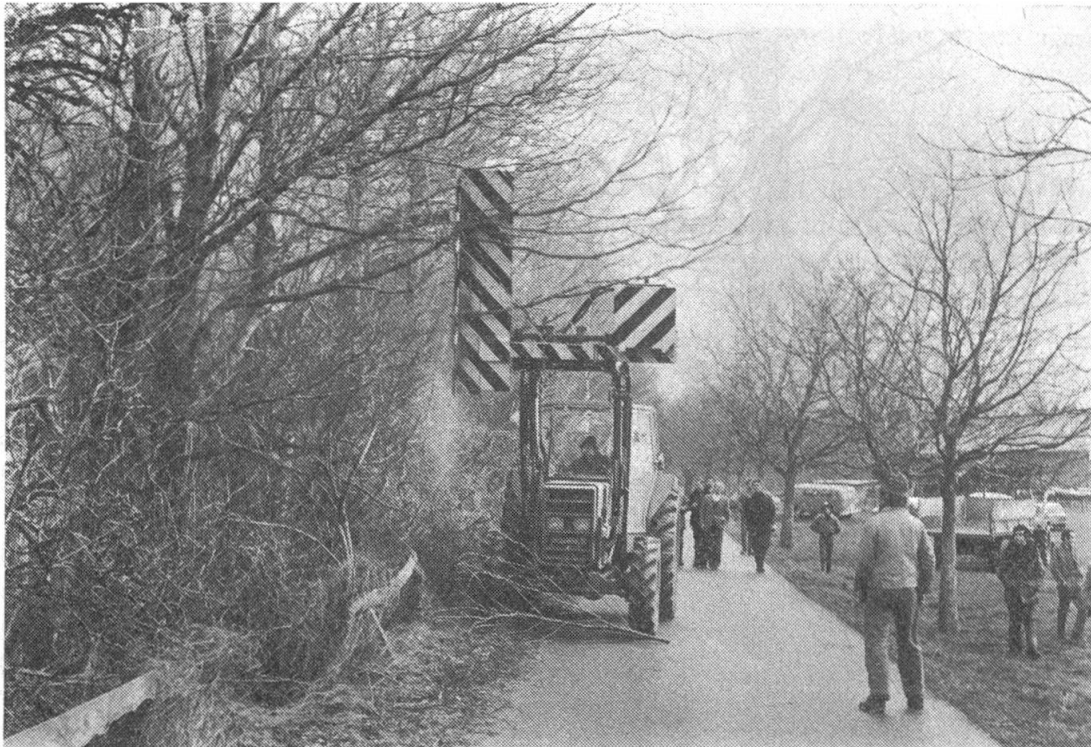
Die Maschine im Einsatz beim zweiten Durchgang auf maximale Schneidhöhe eingestellt.
