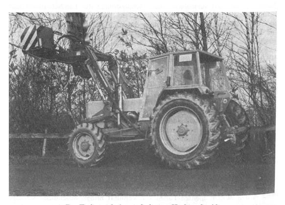
Der Traktor mit dem aufgebauten Heckenschneider.
