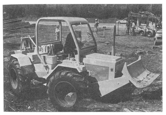
Mit geringeren Dimensionen als die üblichen Knickschlepper wird der HSM-Forstspezialschlepper WS 70 eine Lücke ausfüllen.
