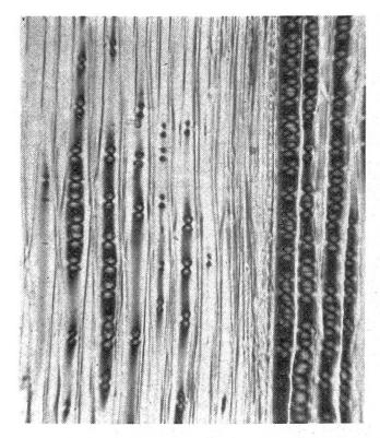
Abbildung I. Radialschnitt durch Holz von Pinus strobus. Im rechten Drittel des Bildes liegt eine Jahrringgrenze. Die Hoftüpfel in den Längstracheiden werden im polarisierten Licht deutlich hervorgehoben (Vergr.: 13:1).
