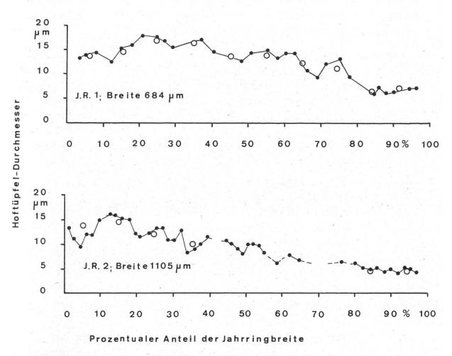
Nomogramm 2. Kurve der Hoftüpfeldurchmesser der Längstracheiden in Jahrringen von 684 μm Breite (1) und von 1105 μm Breite.
