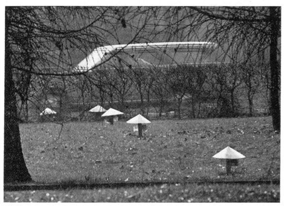
Abbildung 3 Anordnung der Messstellen (Probenehmer) im Bereich einer Laubhecke (der Hut ganz links steht vor der Hecke am Strassenrand).
