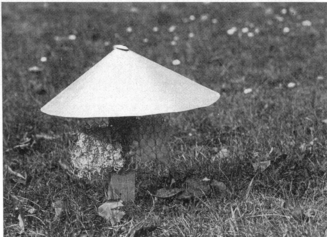
Abbildung 2 Probenehmer. Auf ein Drahtnetz sind Sphagnum-Moos (links) bzw. Glaswolle (rechts) mit Gummibändern aufgespannt worden. Das Drahtnetz wird durch einen Blechhut vor Regen geschützt.
