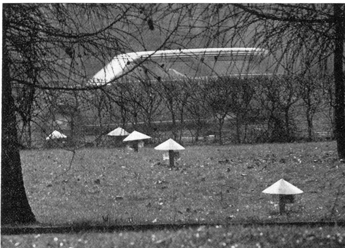
Abbildung 3 Anordnung der Messstellen (Probenehmer) im Bereich einer Laubhecke (der Hut ganz links steht vor der Hecke am Strassenrand).
