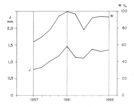
Abbildung 1. Jahrringbreite F-beeinflusster Fichten im «Heimeholz» (J, linke Ordinate) und relativer Wasserverbrauch (W) der Gaswaschanlage (Abluftreinigungsanlage) der Aluminiumfabrik (rechter Ordinatenmassstab) für die Jahre 1957 bis 1966.
