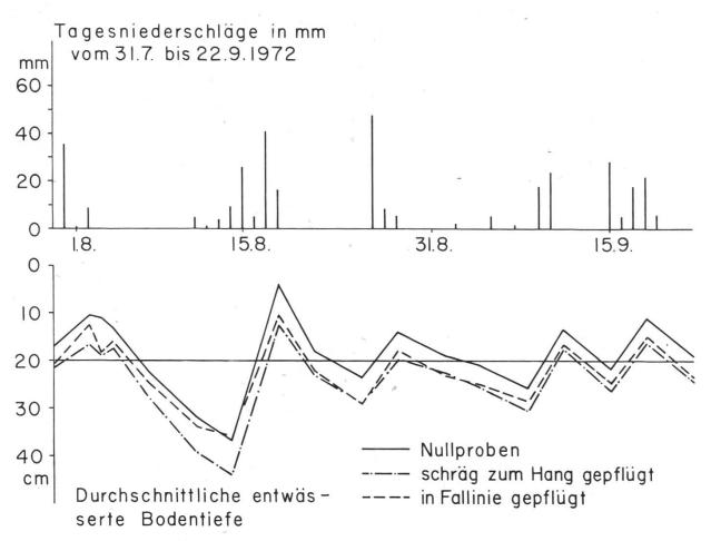
Abbildung 3. Wasserspiegellagen als Funktion der Zeit im Zusatzversuch Plattentobel 1972. Vergleich der Entwässerungswirkung beim Pflügen in Fallinie und Pflügen schräg zum Hang.
